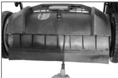
Рис. 12 Снятие крышки корпуса
