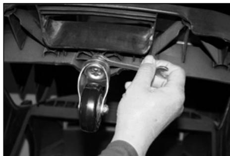
Рис. 16 Проверка затяжки крепления переднего колеса
