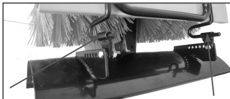
Рис. 5 Установка отвала на кронштейны щетки
