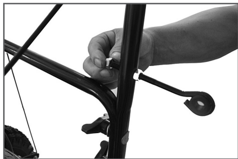
Рис. 13 Монтаж кронштейна рычага поворота желоба
