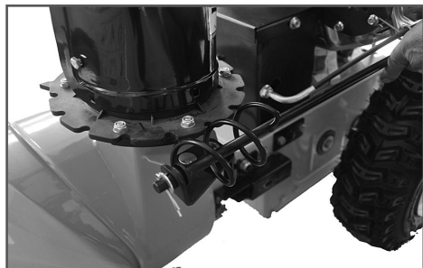
Рис. 12 Установка нижней части рычага поворота желоба
