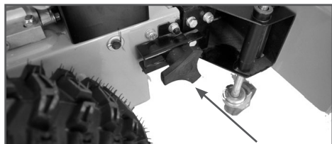
Рис. 7 Отсоединение щетки от корпуса машины
