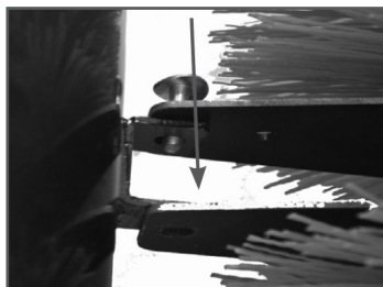
Рис. 6 Соединение отвала и соединительных пластин
