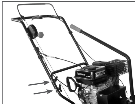
Рис. 4 Установка соединительных пластин крепления отвала
